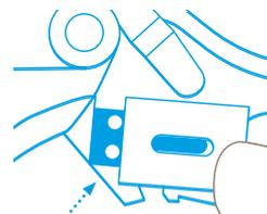
Danach die Klinge links **an der Kante ausrichten** und **exakt** auf den Nocken zurücklegen.
