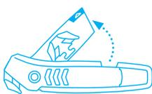
Ziehen Sie das **Klingenmagazin oben heraus**. Dadurch lösen Sie die Arretierung des montierten Klingenkopfes.
